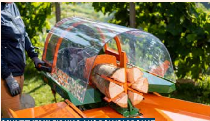
SCHUTZVERKLEIDUNG AUS POLYCARBONAT
