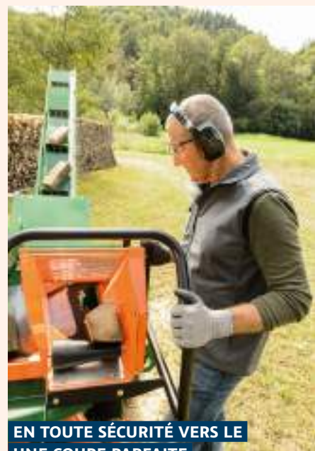
SCIER FACILEMENT DES MORCEAUX DE BOIS AU MÈTRE – GRÂCE À L'UN SYSTÈME D'AVANCE AUTOMATIQUE DU BOIS
