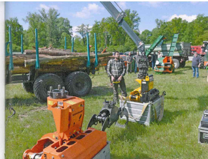
Funkferngesteuerter, werkzeugloser Wechsel vom Fällgreifer auf die leichte und kompakte Greifersäge GMT 035 mittels des Roke-Schnellwechslers. Rechts: Der an einen Moritz FR75 angebaute Stehendspalter Hydro Combi 16 im Praxiseinsatz.
