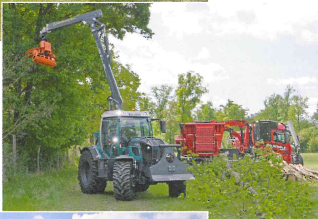
Der Systemschlepper PM-Trac 3830 zeigte, warum er ein Allrounder im Holzrücken und in der Landschaftspflege ist – auch mit der Greifersäge Woodcracker CS 510 von Westtech.
