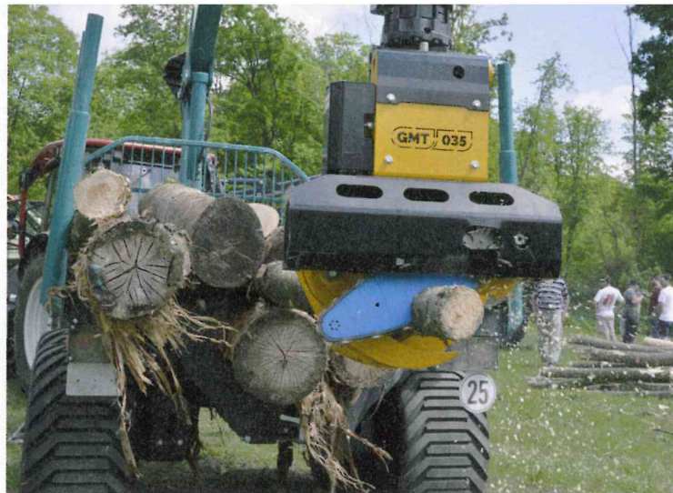
Die Getriebeseilwinde S160 mit Funkfernsteuerung zusammen mit dem Profi-Rückeanhänger P13 im Einsatz. Rechts: Profi-Rückeanhänger P15 mit der kompakten Greifersäge GMT 035. Fotos: Sprenger
