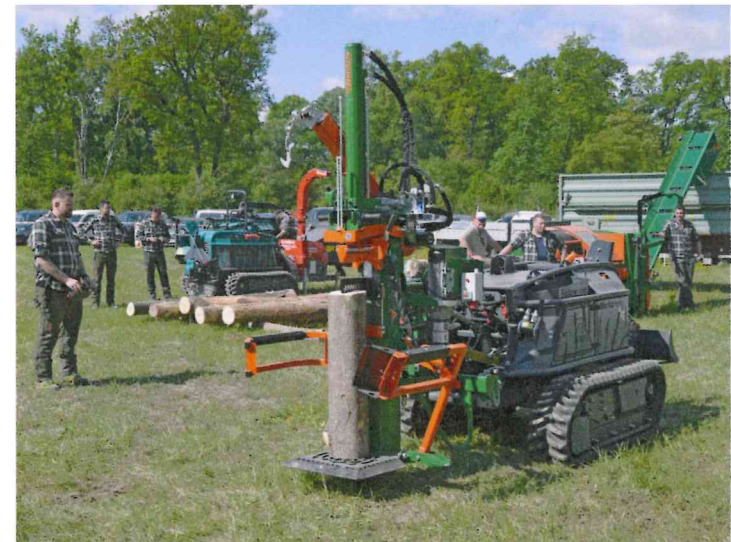
Funkferngesteuerter, werkzeugloser Wechsel vom Fällgreifer auf die leichte und kompakte Greifersäge GMT 035 mittels des Roke-Schnellwechslers. Rechts: Der an einen Moritz FR75 angebaute Stehendspalter Hydro Combi 16 im Praxiseinsatz.
