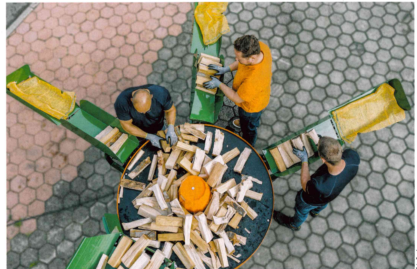
Der Log-Pack von Posch ist eine rotierende Packstation zur manuellen Verpackung von Brennholz.
