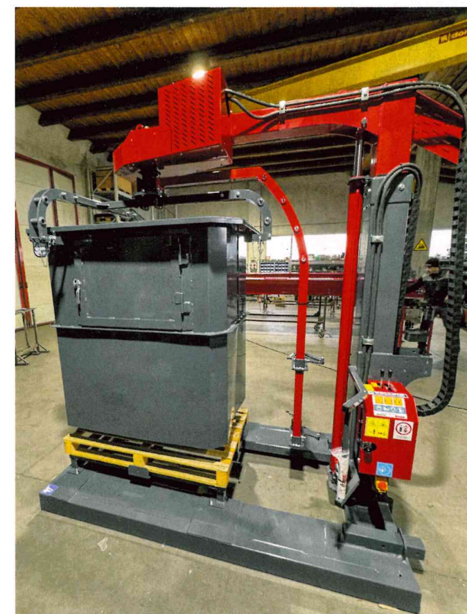
In den eckigen Trommeln von Collino lässt sich Holz durch eine Tür auf Paletten stapeln.
