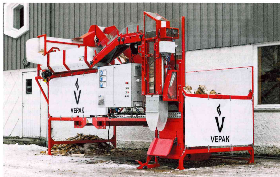
Die Absackanlage von Vepak verdichtet Scheitholz in einer Verpackungskammer.
