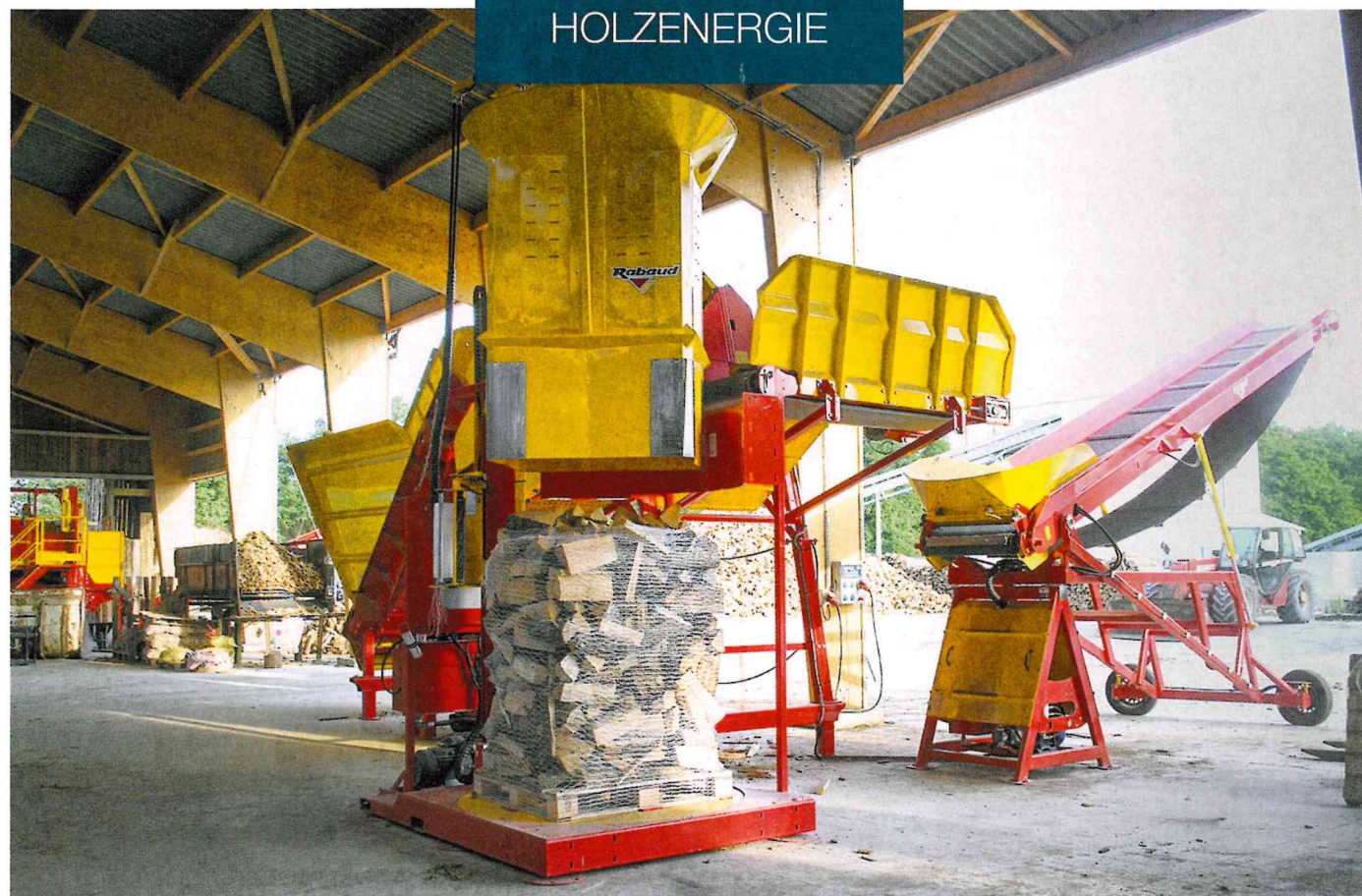
Der Xylopack von Rabaud ist Teil einer industriellen Produktionslinie für Scheitholz.
