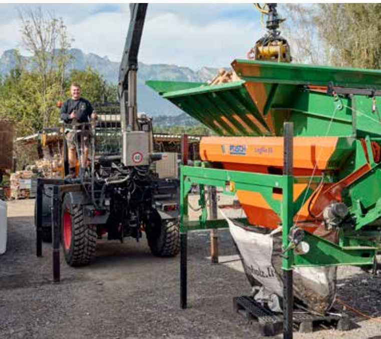
Mithilfe des LogFix wird das Brennholz von Spreißeln sowie Schmutz gereinigt.
