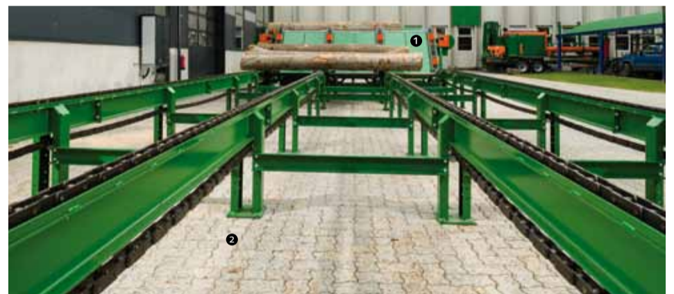
Der LogDeck ② ist die absolute Profillösung für sehr große Holzmassen. Auf dem Quärförderer können, je nach Ausführung, so bis zu 60 fm Holz direkt abgelegt werden.
