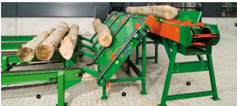
Der Vereinzler LogSep ① sorgt für optimale Separation und Übergabe an die Längsförderer. ② Walzenförderer
