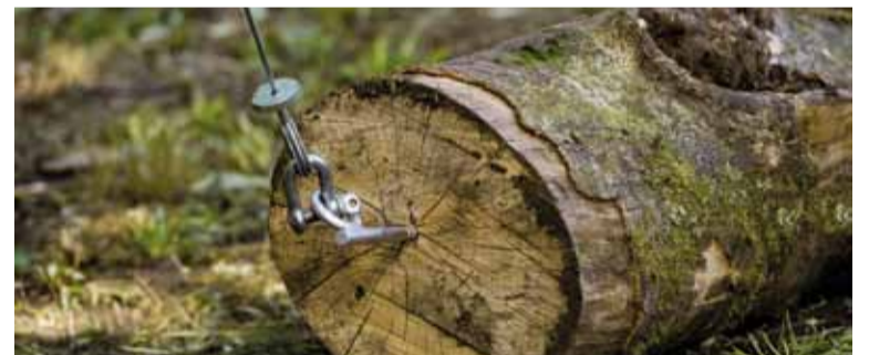
Die Seilwinde mit serienmäßigem Schlagdorn zieht den Holzstamm auch in unwegsamem Gelände bis zum HydroCombi.
