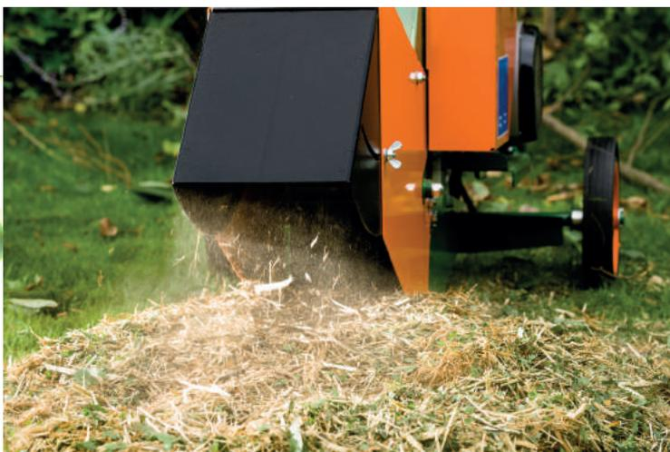
Wie bei Häckslern dieser Bauform üblich, wird das Häckselgut bodennah ausgeworfen und muss zum Transport verladen werden
