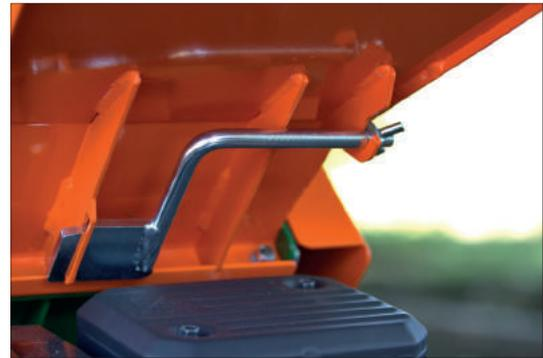
Mit einer Kurbel kann der der Einzug zurückgedreht werden. Sie steckt in einem Halter am Gerät, über dem Motor
