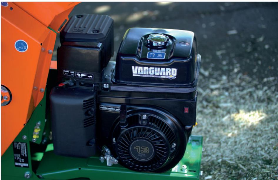
Der Motor, ein Vanguard von Briggs & Stratton, mit Bedieneinheiten. Alternativ gibt es den Häckslers mit 400-V-Elektroantrieb
