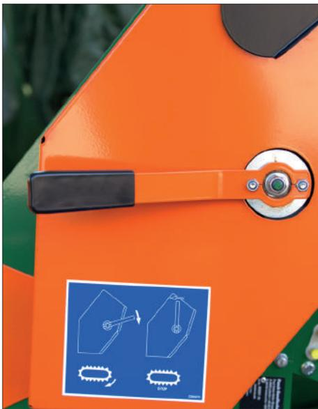
In dieser Stellung ist der Einzug entlastet. Der Einzug ist über einen Keilriemen mit dem Motor verbunden
