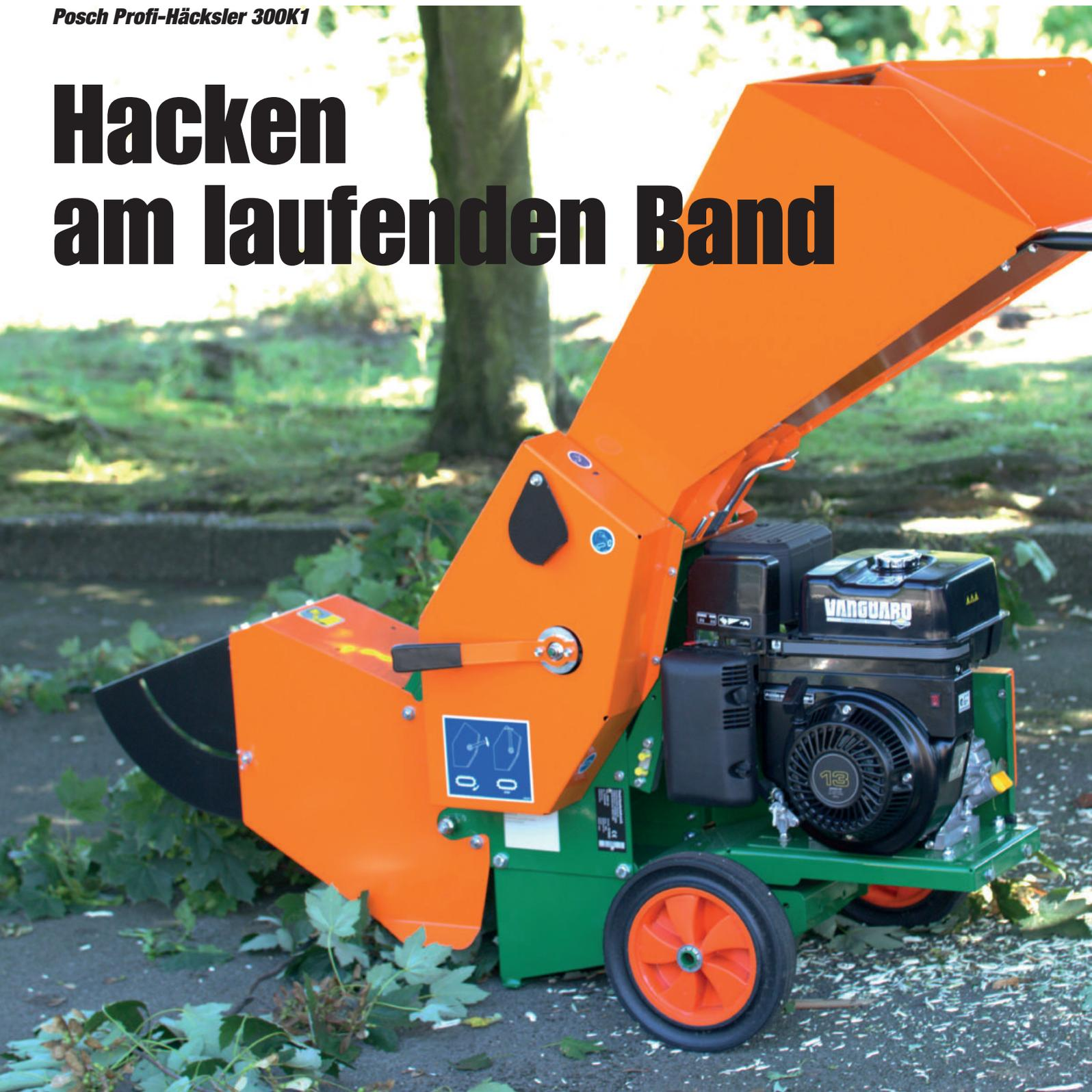
***Mit dem Häcksler 300K1 bietet Posch einen Häcksler der Mittelklasse für Äste bis maximal 5 Zentimetern Durchmesser. Das Gerät gibt es mit Elektromotor, Benzinmotor sowie mit Anschluss für die Zapfwelle. Im Praxistest konnte die Maschine absolut überzeugen.***
