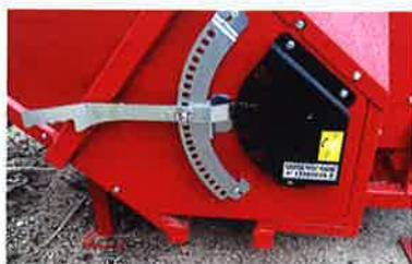
Mit einem Handgriff kann die Schnittlänge in 22 Stufen von 26 bis 50 cm verstellt werden. Dank Langloch lässt sich auch jedes Zwischenmaß einstellen.
