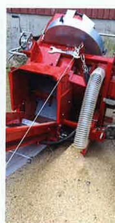
Der Sägemehlauswurf ist genau wie das 5-m-Förderband störungsfrei. Es wird hydraulisch teleskopiert, aber per Seilwinde in der Höhe verstellbar.
