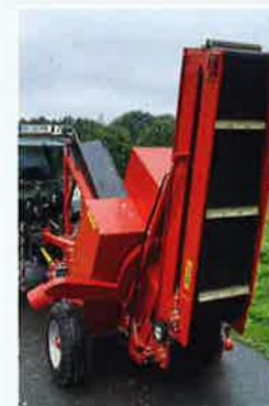
Dank Fahrwerk kann man die Säge gut transportieren, auch wenn es eine Beleuchtung nur auf Wunsch gibt. Der große Sägemehlauswurf kann abgezogen werden.
