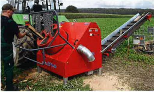
Die Highspeedsäge von EiFo wird ähnlich auch in Blau von Engel und in Grün von Kretzer vertrieben. Die hohe Trommeldrehzahl lässt sich serienmäßig nicht verstellen. Schutzbügel und Ketten sind dauerhaft, erleichtern das Beschicken der Säge aber nicht gerade.
