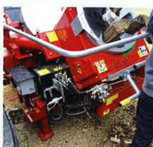
Mit dem Bügel lässt sich die Trommel schnell stoppen und sogar rückwärts drehen. Auch die anderen Bedienelemente sind gut zugänglich. Statt Zapfwelle gibt es auch einen 9,2-kW-Elektromotor.
