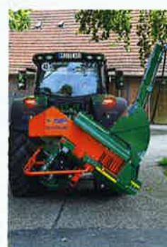
Die Säge wiegt 960 kg und ist eigentlich kompakt. Leider steht das Förderband aber rechts über und fast das ganze Gewicht lastet auf dem rechten Unterlenker. Es gibt keine Beleuchtung.
