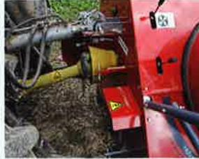
Der Zapfwellenstummel sitzt für kleine Traktoren fast zu hoch und der Stecker samt Phasenwender für den optionalen E-Antrieb ist tief unten. Genauso sollte zumindest der Hebel für den Trommelantrieb besser erreichbar sein.
