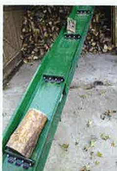
Das Förderband ist vergleichsweise schmal, läuft aber zuverlässig. Es besteht aus einzelnen Segmenten, die schnell und kostengünstig ausgetauscht werden können.
