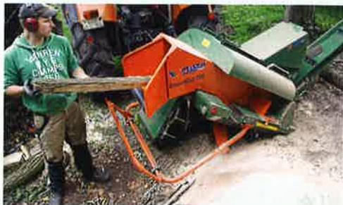
Die SmartCut von Posch macht zwar „nur“ 25 Schnitte pro Minute, läuft aber sehr zuverlässig. Außerdem ist der Arbeitsablauf ruhiger; und es können größere Scheite gesägt werden als bei den Trommelsägen. Mit dem Schutzbügel lässt sich der Ablauf jederzeit stoppen.
