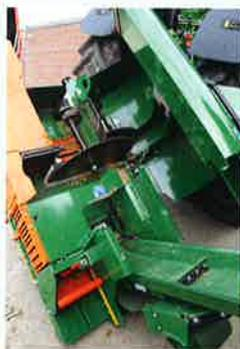
Das 700er Sägeblatt ist 5 mm stark und sehr einfach zugänglich. Zum Abschmieren liegen sogar Schmierleitungen nach draußen.
