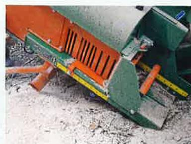
Die Verstellung der Schnittlänge geht werkzeuglos in 11 Stufen von 15 bis 52 cm. Der Sägemehlauswurf sitzt tief am Boden und ist verstopfungsanfällig.
