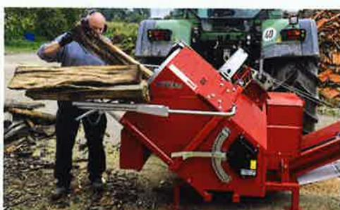
Die Trommeldrehzahl der Quatromat von Unterreiner ist verstellbar, maximal sind 77(!) Schnitte/Minute. Dann sind die Holzablage und ein zweiter Mann sehr hilfreich. Die Einwurfschächte sind kleiner als bei den anderen Testkandidaten, aber heute sind die Kanten angefasst, um das Nachrutschen zu verbessern.
