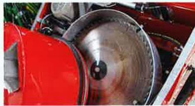
Der Motor hat 11 kW, das 700er Blatt ist unter der Haube besser zugänglich, als der Schmiernippel dahinter. Die kleinen Rollenslager stabilisieren das Blatt, waren bei uns aber bereits teilweise festgelaufen.
