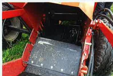
Zum Ändern der Schnittlänge muss man den Anschlag umbauen. Fünf Längen zwischen 18 und 50 cm sind möglich. Für die Umbausätze gibt es keine „Parkmöglichkeit“.
