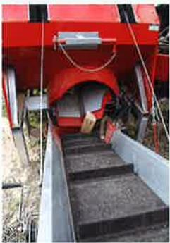
Das 4,50 m lange Teleskop-Förderband wird per Handkurbel in der Höhe verstellt, lässt sich aber hydraulisch um +/- 15° schwenken!
