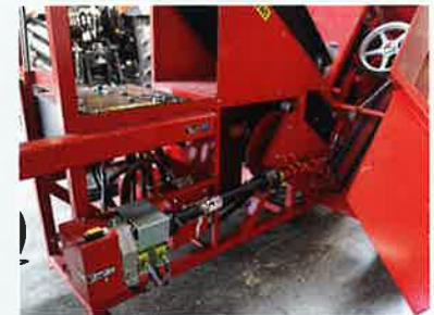
Unter der linken Verkleidung der Antrieb für die zwei Ölpumpen und das Sägeblatt – wahlweise per Gelenkwelle oder 11-kW-Motor. In der Mitte der hydraulisch angetriebene Exzenter für die Sägewippe.
