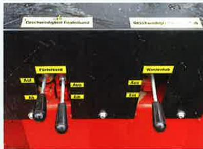
Die Bedienung ist auf der rechten Seite gut zugänglich und einfach verständlich. Auch das Förderband wird hydraulisch in der Höhe verstellt.
