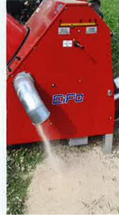
Der große Sägemehlauswurf sitzt schön hoch und ist ziemlich verstopfungssicher. Die Schnittlänge lässt sich stufenlos und bequem hydraulisch von 20 bis 50 cm verstellen.
