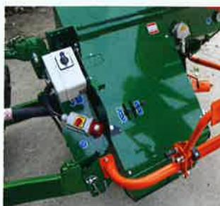
Der Dreipunktbau ist kompakt und alternativ zur Zapfwelle geht auch der E-Motor mit 11 kW. Neben dem Schaltkasten sind die Hebel für das hydraulische Teleskop-Förderband.
