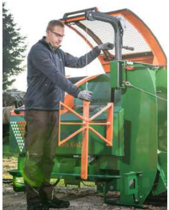
Für einen leichteren Wechsel des Spaltmessers bietet sich eine Handseilwinde optimal an. Artikel Nr. F0004317
