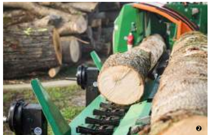
Stetige Versorgung mit dem Stammfördersystem, bestehend aus ① Querförderer und ② Längsförderer.
