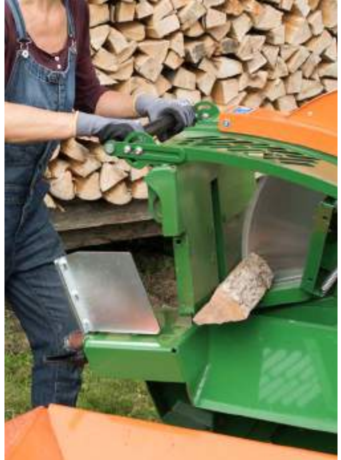
Die Sicherheitsklappe mit ergonomischer Höhenverstellung: Der Gefahrenbereich ist abgedeckt.
