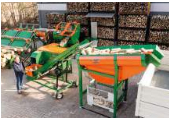
LogFix L Holzreste werden an einen passenden Container oder ein optionales Förderband übergeben (Abbildung mit Option L).
