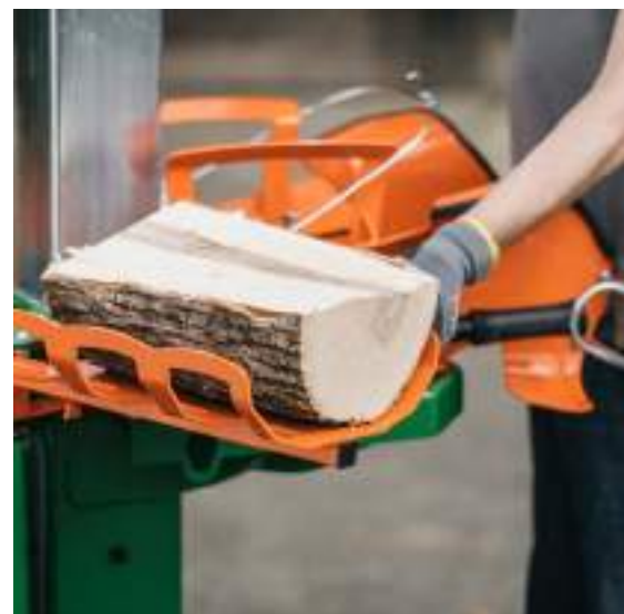
Zu spaltende Holzstücke, aber auch bereits gespaltenes Scheitholz können bequem auf den Holzablagen – die sich auf beiden Seiten befinden – abgelegt werden.
