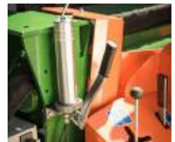
Integrierte Schmiervorrichtung über Handpumpe (optional erhältlich)
