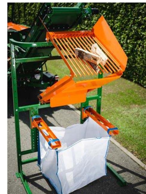
Les bûches nettes sont par ex. transmises à un autre convoyeur, ou chargées directement dans une remorque.
