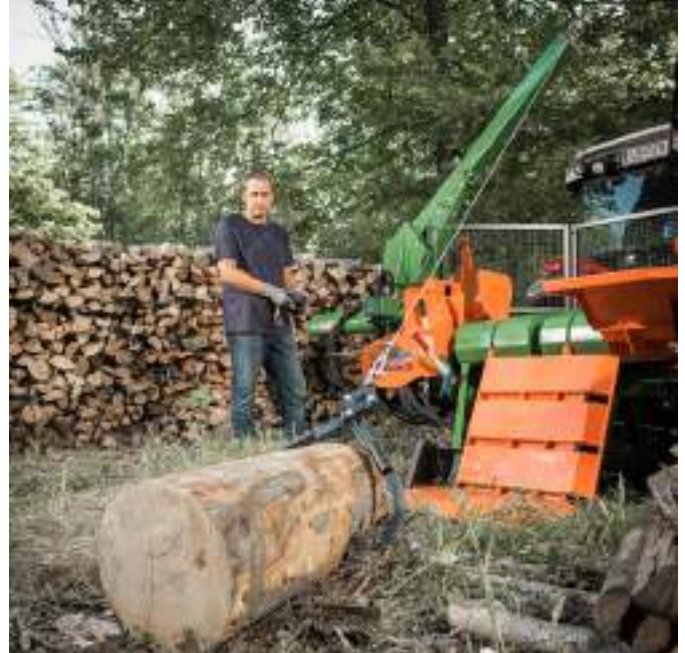
Die optionale Seilwinde zieht die Stämme kraftschonend zur Verarbeitung.
