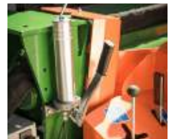
Integrierte Schmiervorrichtung über Handpumpe (optional erhältlich)
