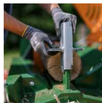
Oscar: Das optionale 4-fach-Wendespalkkreuz kann beidseitig für verschiedene Holzdurchmesser verwendet werden.
