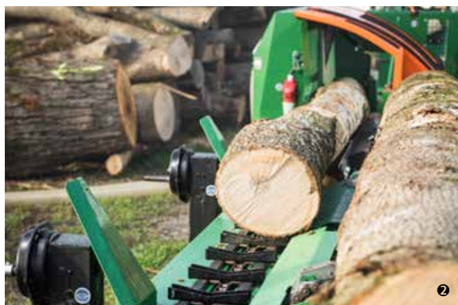
Stetige Versorgung mit dem Stammfördersystem, bestehend aus ① Querförderer und ② Längsförderer.
