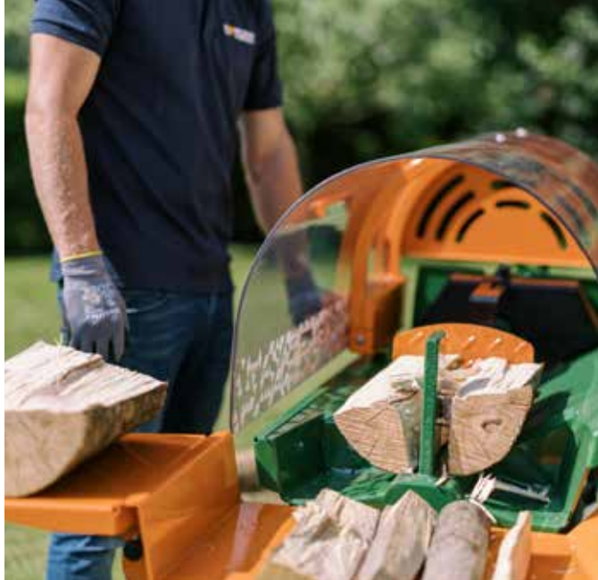
Einfach zu Brennholz – mit dem serienmäßigen 2-fach-Messer, mit optionaler Zusatzablage (F0005685).
