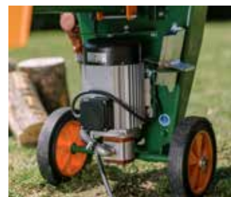
Der starke 5,5-kW-E-Motor im Detail. Zu sehen ist auch die Parkvorrichtung des Spaltmessers auf der Rückseite.
