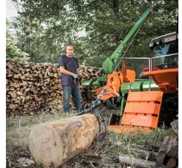
Die optionale Seilwinde zieht die Stämme kraftschonend zur Verarbeitung.
