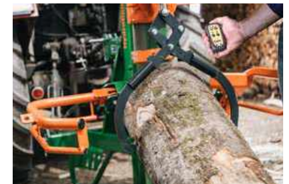
Die Seilwinde mit optionaler Greifzange und Funkfernbedienung für den leichten Transport schwerer Stämme.
