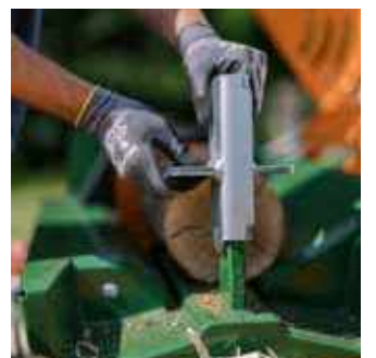
Oscar: Das optionale 4-fach-Wendespaltkreuz kann beidseitig für verschiedene Holzdurchmesser verwendet werden.
