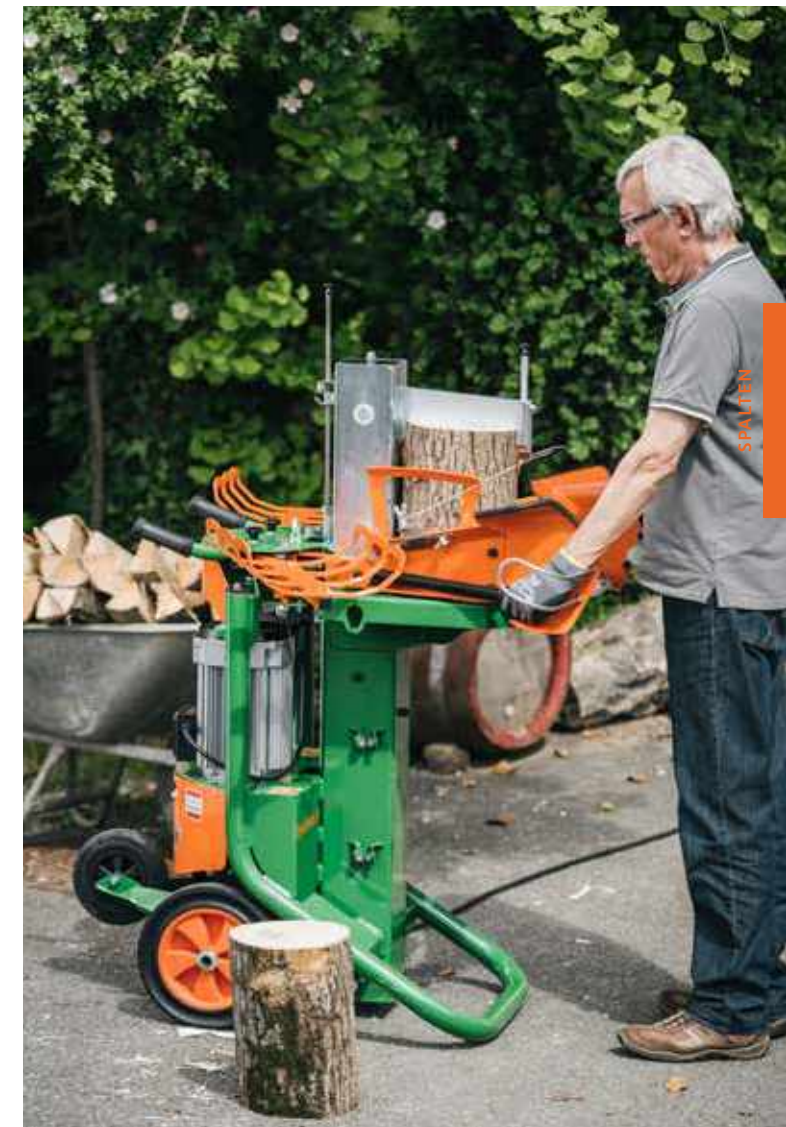
Die SpaltAxt 10 hat ein 26 cm langes Spaltmesser, mit dem auch größere Holzdurchmesser (bis 40 cm) verarbeitet werden können.
