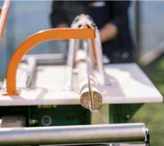
NEU: mit dem Kreissägenanbau teilen Sie Pfähle einfach in zwei Hälften.
