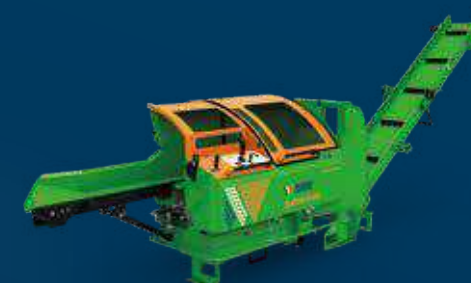
SpaltFix K-415 Stammdurchmesser max. 41 cm
