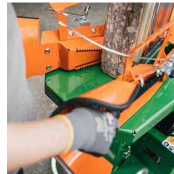
Durch die Holzfixierautomatik bei der SpaltAxt 6 wird ein bequemes und gefahrloses Spalten ermöglicht.
