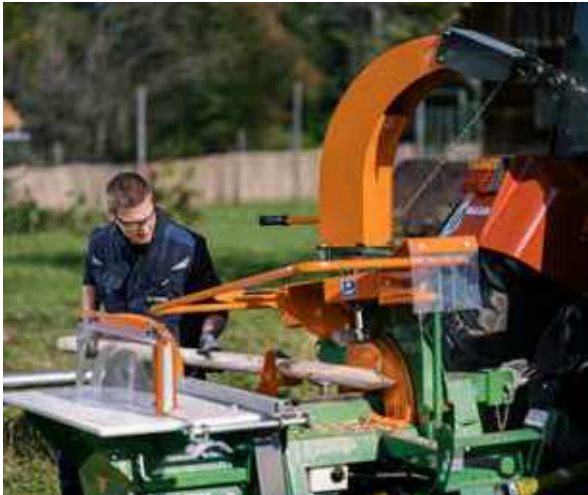
Mit dem eigentlichen SchälProfi entrinden und spitzen Sie Stämme. Mit dem Kreissägenanbau trennen Sie diese bei Bedarf in der Mitte durch.
