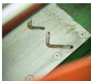
Integrierte Schmiervorrichtung über Handpumpe (optional erhältlich)
