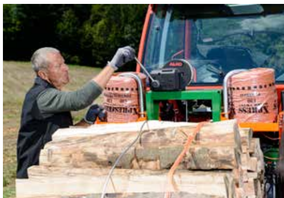
Mithilfe der Seilwinde wird das Holzbündel vorgespannt.
