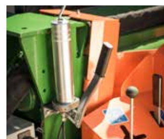
Integrierte Schmiervorrichtung über Handpumpe (optional erhältlich)
