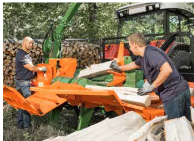
Mit dem serienmäßigen Sicherheitspaket dürfen mehrere Personen am SplitMaster arbeiten.
