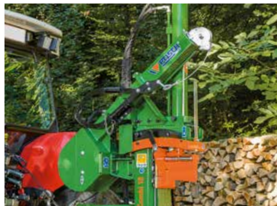
Bei der Seilwinde „750“, 40 m Seil und 750 kg Zugkraft ist die Auslaufgeschwindigkeit unbegrenzt. Für HydroCombi 16, 18, 20, 22, 24 und 26 (Symbolbild). Artikel-Nr. HW
